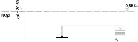
Figure 8 Position of the plastic neutral axis for SPP specimen Slika 8. Položaj plastične neutralne osi za SPP uzorak
