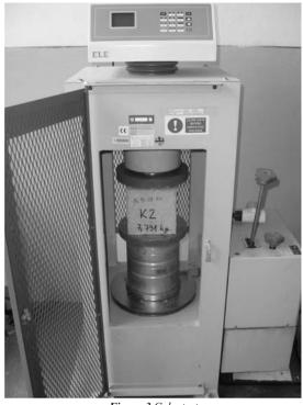
*Figure 3* Cube test *Slika 3.* Ispitivanje kocke
