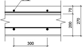
Figure 1 Cross section and longitudinal section of SPC specimen Slika 1. Poprečni i uzdužni presjek SPC uzorka
