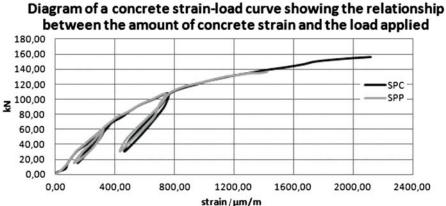
Figure 20 Diagram of a concrete strain-load curve showing the relationship between the amount of concrete strain and the load applied Slika 20. Dijagram krivulje deformacija-opterećenje betona koji prikazuje odnos između iznosa deformacije betona i primijenjenog opterećenja
