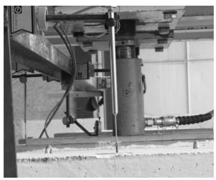
Figure 13 Inductive sensor above the support Figure 13. Indukcijski senzor iznad nosača
