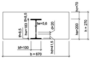
*Figure 5* Cross section dimensions for SPC specimen *Slika 5.* Dimenzije poprečnog presijeka za SPC uzorak
