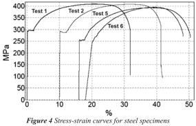
Slika 4. Krivulje naprezanje-deformacija za čelični uzorak
