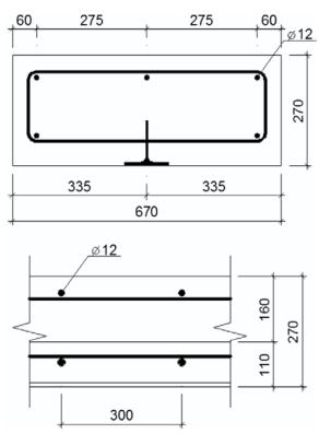
Figure 2 Cross section and longitudinal section of SPP specimen Slika 2. Poprečni i uzdužni presjek SPP uzorka
