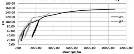
Figure 19 Diagram of a steel strain-load curve showing the relationship between the amount of steel strain and the load applied Slika 19. Dijagram krivulje deformacija-opterećenje čelika koji prikazuje odnos između iznosa deformacije čelika i primijenjenog opterećenja
