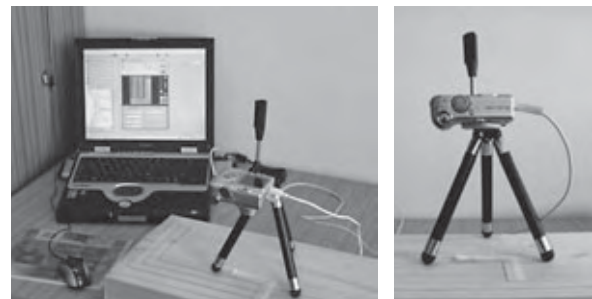
Figure 5 Apparatus for measuring the kerf width Slika 5. Oprema za mjerenje širine propiljka
