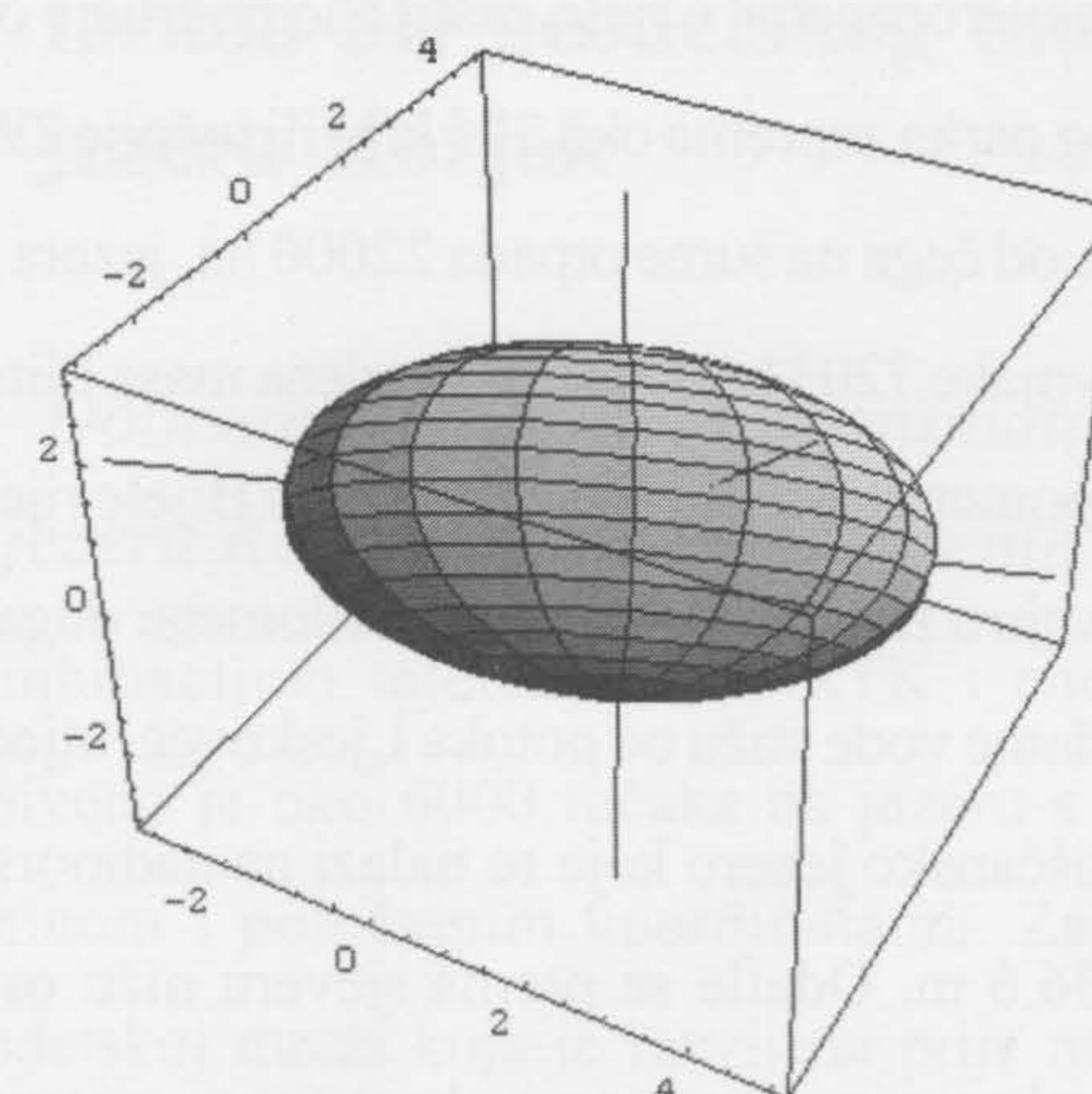
2. Prikaz elipsoida zarotiranog i translatiranog u prostoru
