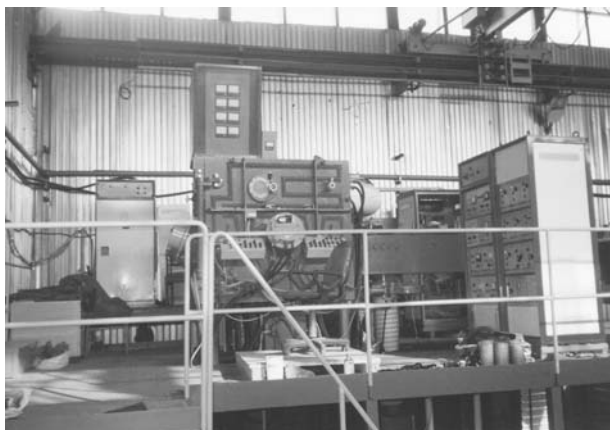
Figure 2. General views of electron-beam installation for obtaining composite materials for electrical contacts Slika 2. Pogled na elektro-lučno postrojenje za pridobivanje kompozitnih materijala za elektro-lučne kontakte
