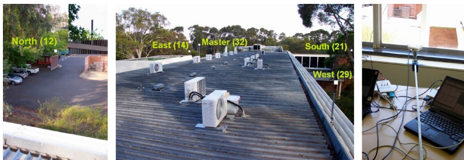
Slika 15. Konfiguracija LocataNet mreže (lijevo i sredina) te položaj Locata antene pri statičkom pozicioniranju (desno) prilikom prvog testiranja pozicioniranja u zatvorenom prostoru (Rizos i dr. 2003).
