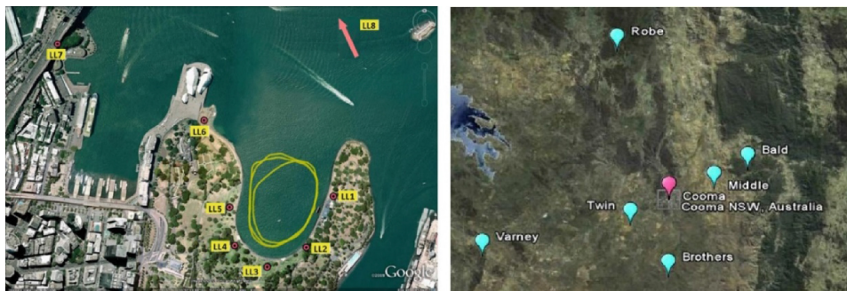
Slika 13. Konfiguracija LocataNet mreže i područje testiranja navigacije pomorskih vozila (lijevo) (Jiang i dr. 2013a), te zrakoplova (desno) (Jiang i dr. 2013c).
