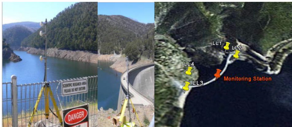
Slika 14. Tumut Pond brana s prikazanim položajem Locata uređaja (Choudhury i Rizos 2010).
