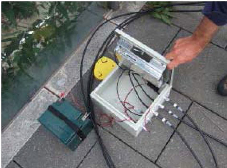
Slika 5. LocataLite unutar kutije s priključkom na antene (Rizos i dr. 2010).
