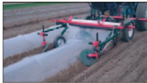
Stroj za formiranje tunela izvodi tunel širine 60 do 200 cm i visine 40 do 100 cm. Mehanizirano pokrivanje povrća bez noseće konstrukcije izvodi se istovremeno sa sadnjom ili naknadno poslije obavljene sjetve ili sadnje. Skupljanjem polimernih materijala i njihove prerade, dobivaju se vrlo vrijedne sekundarne sirovine.
