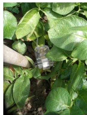
Slika 4. i 5. Mjerni uređaj "iMetos" sa senzorom vlaženja lišća u međimurskom krumpirištu. Snimio M. Šubić.
