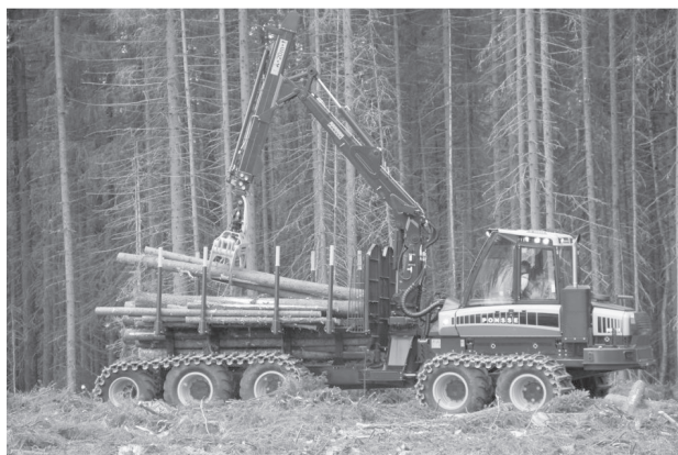
Slika 1. Ponsseov desetokotačni forvarder Fig. 1 Ponsse ten-wheel forwarder
