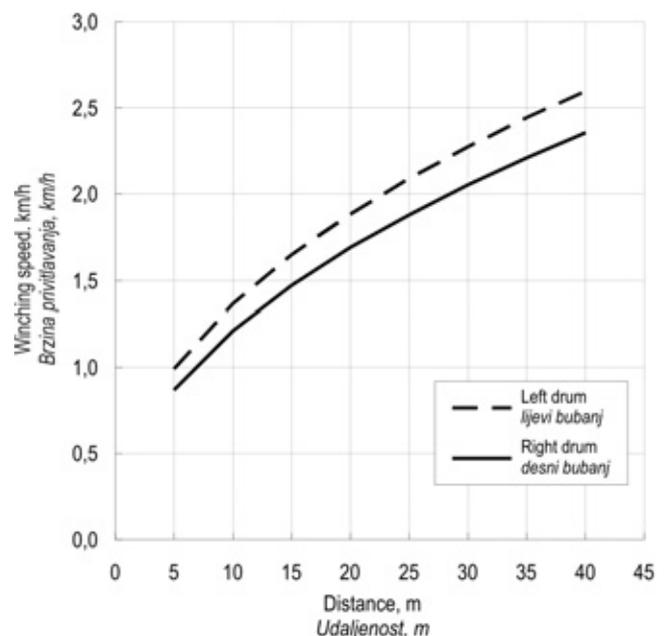
**Figure 7** Winching speeds of the left and right drum**Slika 7.** Brzine privitavanja lijevoga i desnoga bubnja
