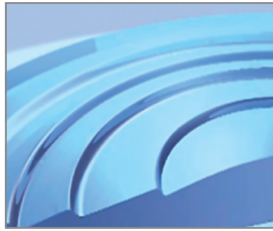
SLIKA 5. Apodizacija – različita visina stepenica unutar optike AcrySof ReSTOR leće
