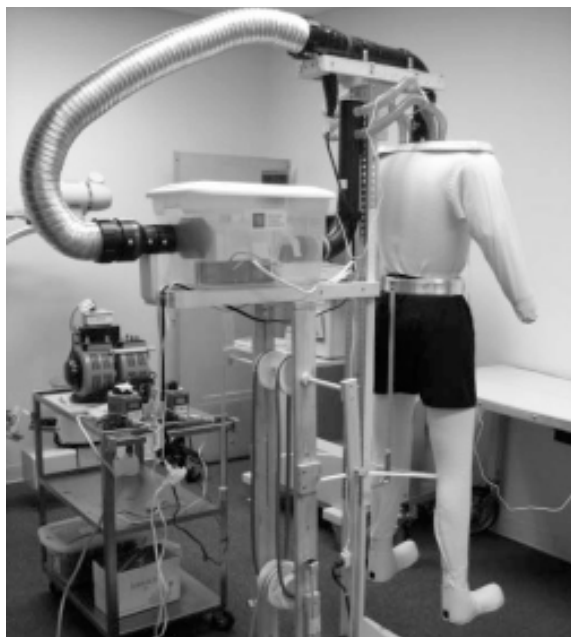
Figure 2. Inflatable thermal manikin used for assessing the effectiveness of the prototype reflective vests Slika 2. Termalni maneken na napuhavanje korišten za ocjenjivanje učinkovitosti reflektirajućeg prsluka
