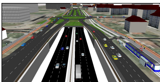
Slika 15 - Portal tunela i kružni tok prometa na produženoj Miramarskoj cesti, pogled od ulice HBZ [5]
