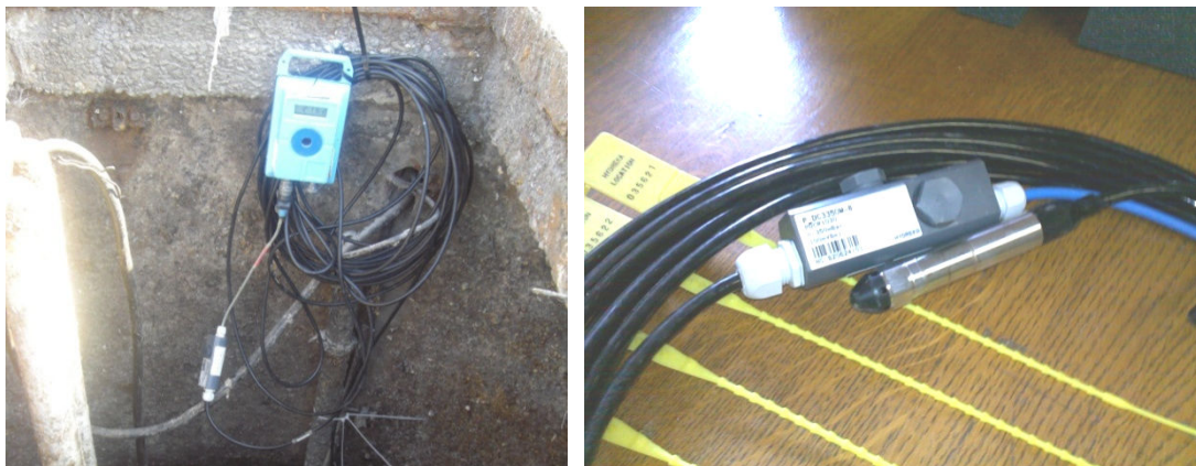
Slika 8 - Pijezometrijska sonda i zapisivač podataka
