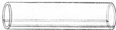
Slika 35. Cijev trstike; crtkano je označena trijeska, koja će se odsjeći za izrađivanje piska, \frac{1}{2} nar. vel.
