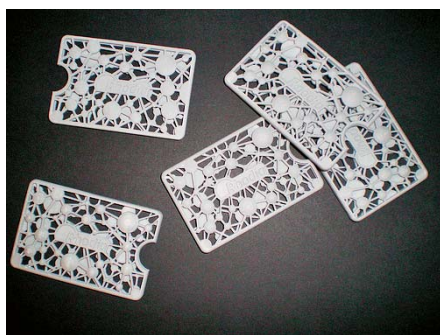
SLIKA 6 – Izradak načinjen novim Rhodijinim poliamidnim prahom za brzu izradbu prototipova (Foto: Rhodia )
