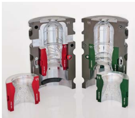
SLIKA 11 – Izmjenjivi kalupi za puhanje (Foto: Sidel)
