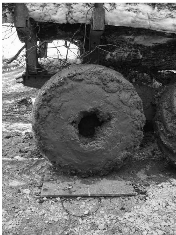
Slika 3. Mjerenje osovinskoga opterećenja vozila i konusnoga indeksa Fig. 3 Measuring of vehicle axle load and cone index
