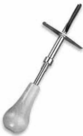
Slika 4. Švedski instrument za mjerenje kore
