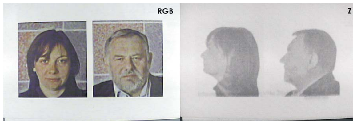
Figure 10 Recording results of Infradesign secured portraits with embedded hidden photo of profiles for the security documents (RGB image, Z image) Slika 10. Rezultat snimanja experimentalnih Infradesign zaštićenih portreta sa skrivenom slikom profila za sigurnosne dokumente (RGB slika, Z slika)
