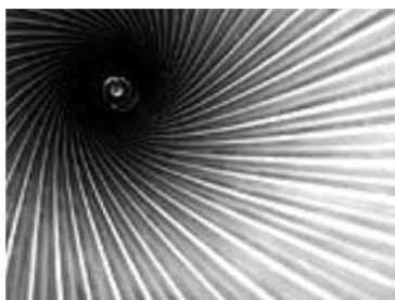
Figure 1 View of grooved barrel bore Slika 1. Pogled na ožljebljeni kanal cijevi
