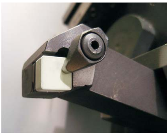
Figure 4 The tool-holder with clamped ceramic cutting insert Slika 4. Držać alata s pričvršćenim keramičkim uloškom
