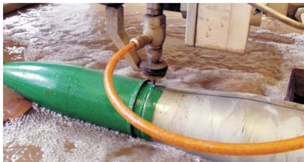
Figure 2 Experimental cutting of anti tank bullet with AWJ Slika 2. Eksperimentalno rezanje protutenkovskog metka s abrazivnim vodenim mlazom
