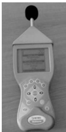
Slika 3. Mjerni instrument Multinorm M1620 sa zvučnom sondom oznake A1146
