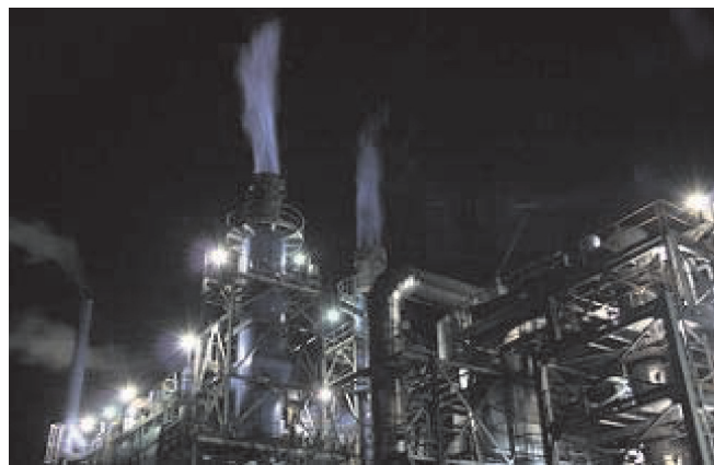
Slika 6 – Spaljivanje sumporovodika na postrojenju za proizvodnju čađa
