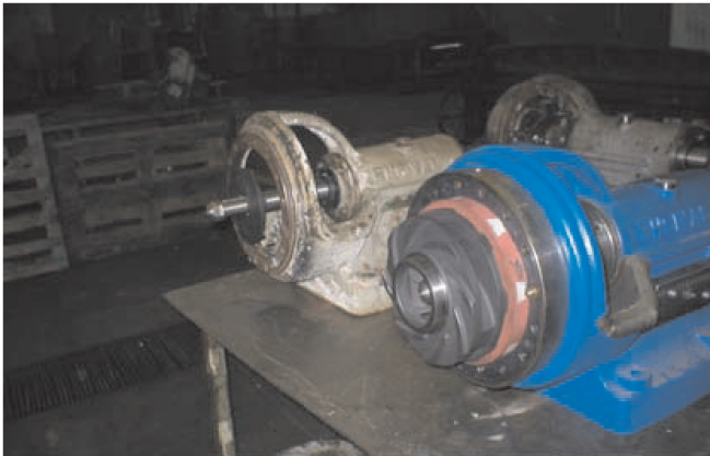
Slika 9 – Crpka prije i poslije reparacije
