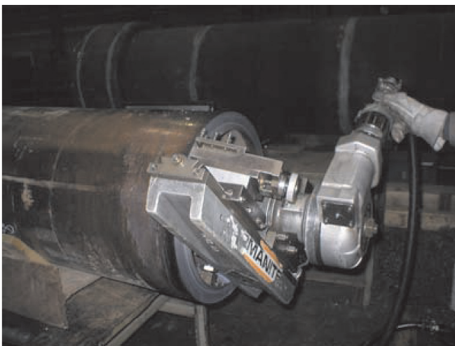
Slika 11 – Strojna obrada na mjestu (on site machining)
