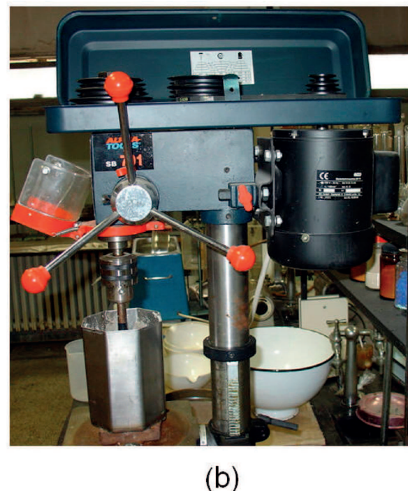
Slika 4. Laboratorijska atricijska ćelija (a) i pogon impelera (b) Figure 4 Laboratory attrition cell (a) and impeller drive (b)
