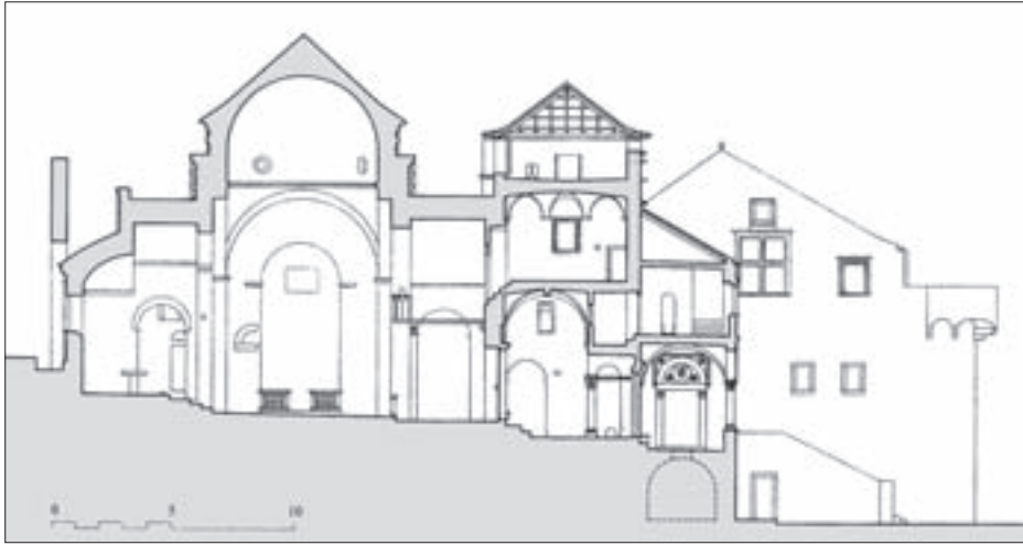
SL. 3. CRKVA SV. MARIJE NA MLJETU: UZDUŽNI PRESJEK KROZ CRKVI S POGLEDOM PREMA JUGU, STANJE 1998. FIG. 3 CHURCH OF ST MARY, MLJET: LONGITUDINAL SECTION LOOKING SOUTH, 1998
