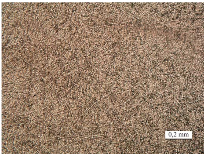
SLIKA 8 – Mikrografija poliamida s dodanim česticama staklenih vlakana
