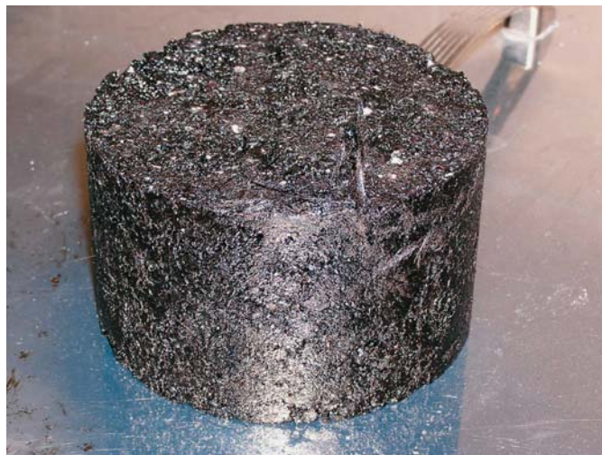
SLIKA 15 – Ispitno tijelo promjera oko 101,5 mm asfaltna mješavine s vlaknima
