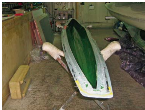
SLIKA 1 □ Kalup premazan voskom s nanesenim slojem prozirne gelne prevlake (Foto: R. Šurina)
