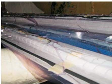
SLIKA 4 □ Natapanje laminata smolom (natopljeni laminat je tamniji) (Foto: R. Šurina)
