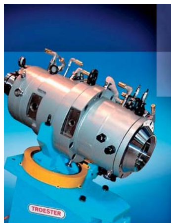
SLIKA 2 – Alat za troslojno ekstrudiranje
