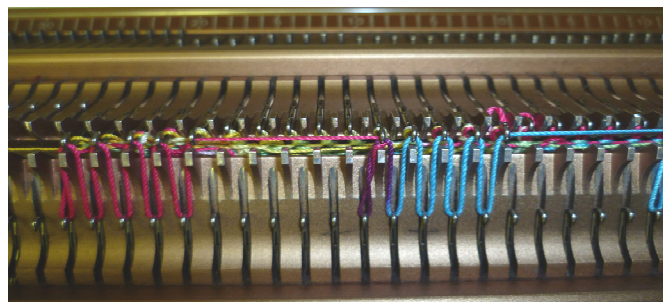
Slika 11. Privremeno učvršćivanje pređe koja oblikuje petlje pomoću igala prednje iglenice
