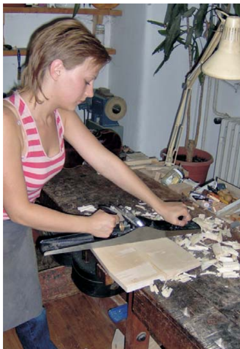
Slika 33. Zbirka Schneider, Zagreb, Trg maršala Tita 11, učenica pri obradi podnice violine velikom blanjom, 2006.
