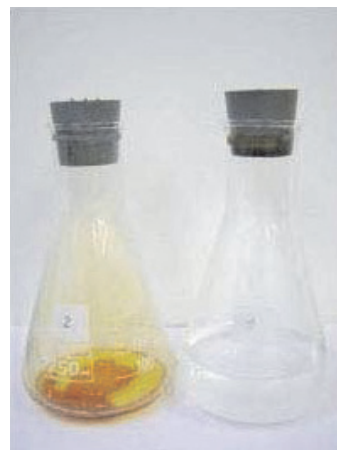
Slika 6 – Tikvice s uzorcima tijekom određivanja jodnog broja (A) i nakon titracije (B)
