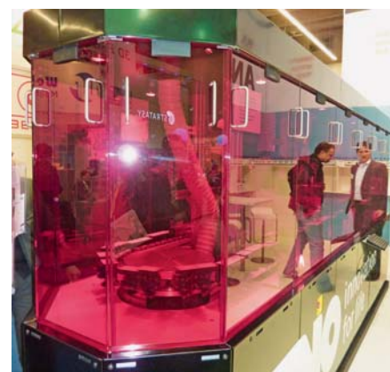
SLIKA 6 – TNO uređaj koji radi na načelu DLP -a (Foto: A. Pilipović)
