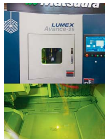
SLIKA 9 – Stroj koji se temelji na konceptu jedan stroj, dva postupka ( SLM + glodanje) (Foto: A. Pilipović)
