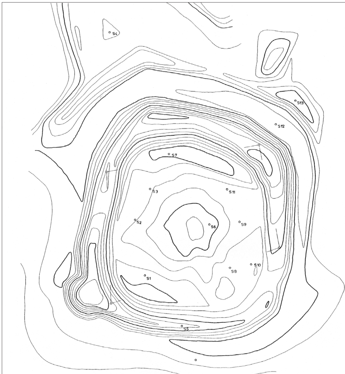
Slika 4. Geodetski snimak lokaliteta iz 70-ih godina 20. stoljeća s označenim položajima probnih sondi holandskim svrdlom
