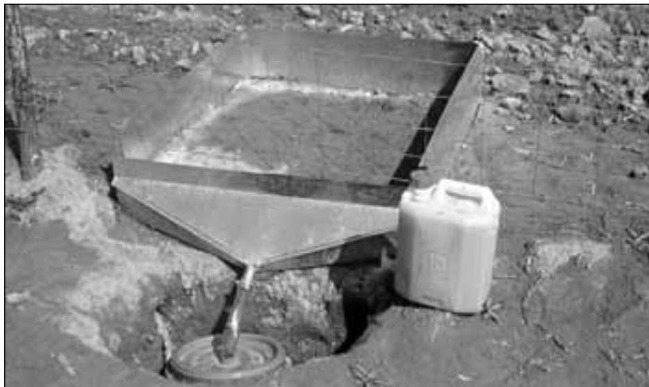
Fig. 1 One-meter-square closed erosion plot for measuring interrill soil erosion on bare soil Sl. 1. Zatvorena parcela površine 1 m 2 za mjerenje plošne erozije na golom tlu
