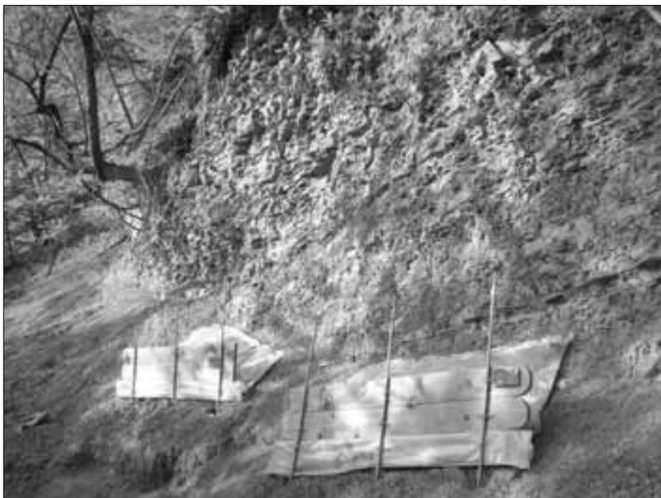
Fig. 5 Semi-open erosion plots for measuring sediment production Sl. 5. Poluotvorene erozijske parcele za mjerenje količine novonastalog sedimenta
