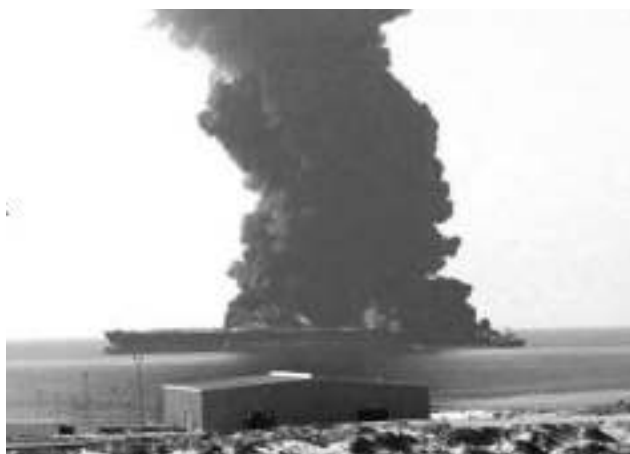
Slika 6: Golemi požar relativno novog (2000.) francuskog supertankera Limburg (dulj. 332 m, šir. 58 m; kapaciteta 2,16 milijuna barela), 18 s 397 000 barela (preko 63 milijuna litara) sirove nafte (koju je prevezio iz Irana u Maleziju), nakon (samoubilačkog) bombaškog napada malim gumenim gliserom natovarenim eksplozivom (tragovi TNT-a nađeni su pored mjesta bočnog proboja dvostrukih čeličnih stijenki desne strane broda), 6. listopada 2002., dok je u Adenskom zaljevu (Jemen) čekao poziv za ukrcaj dopunskih količina sirove nafte
