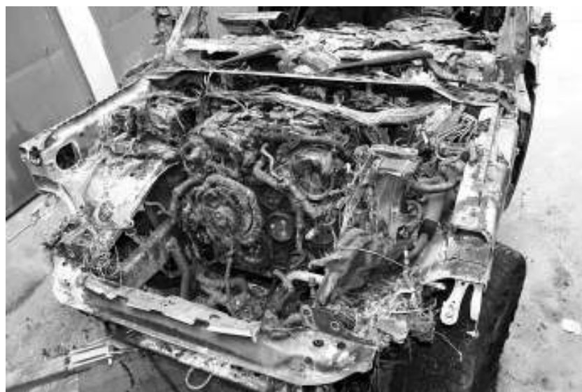
Slika 2: Primjer istjecanja goriva iz pumpe na ispušni sustav
