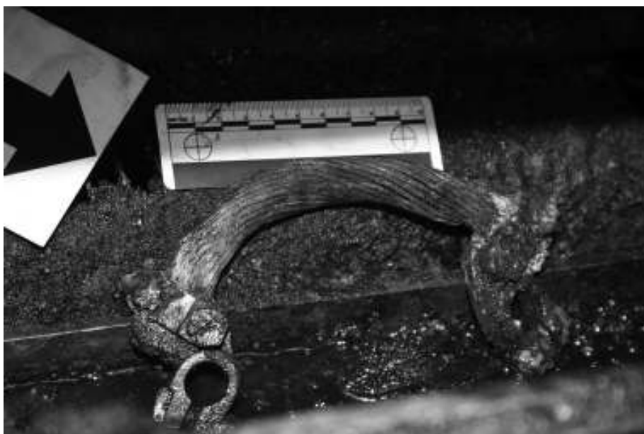
Slika 5: Primjer kratkog spoja plus vodiča s masom pri mirovanju vozila (radni stroj)
