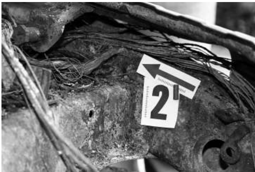
Slika 4: Primjer kratkog spoja plus vodiča s masom pri mirovanju vozila
