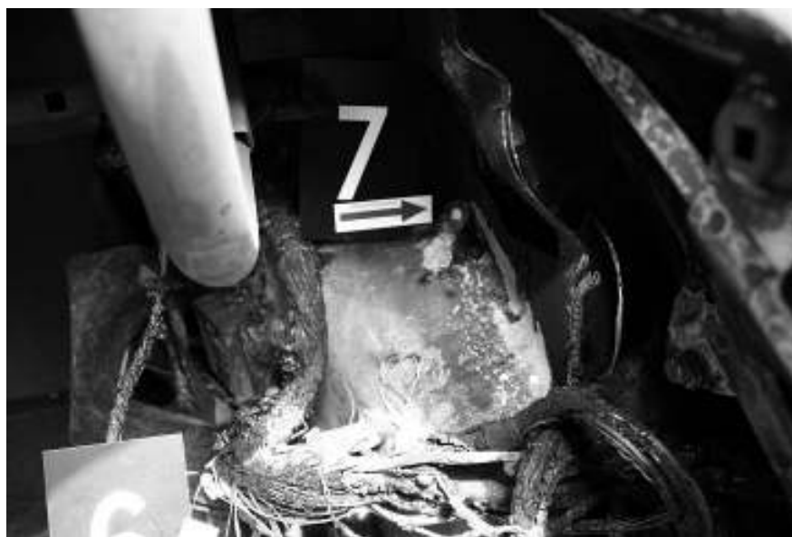
Slika 3: Kratki spoj plus vodiča s limom blatobrana
