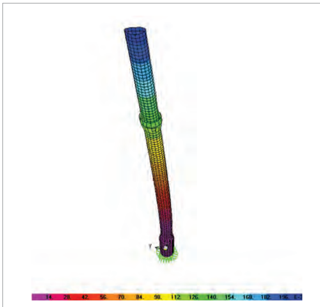
Slika 4. Zakrivljenost konture i bočni pomak po visini minareta (mm) [6]
