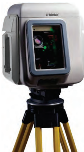
Slika 3 Skener Trimble GX Advanced
