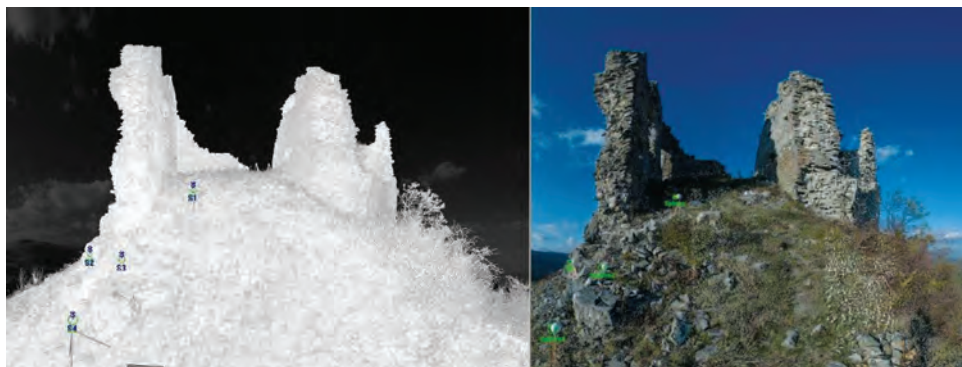
Slika 5 Oblak točaka dobiven mjerenjem starog grada Modruša, prije (lijevo) i nakon bojanja (desno)
