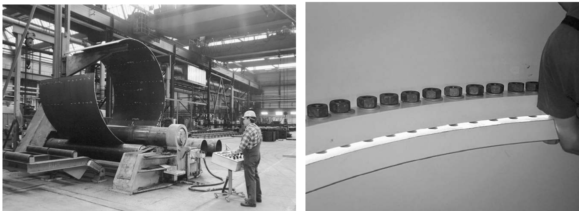
Slika 4 - Proizvodnja i detalj spoja segmenta čeličnog stupa [1]
