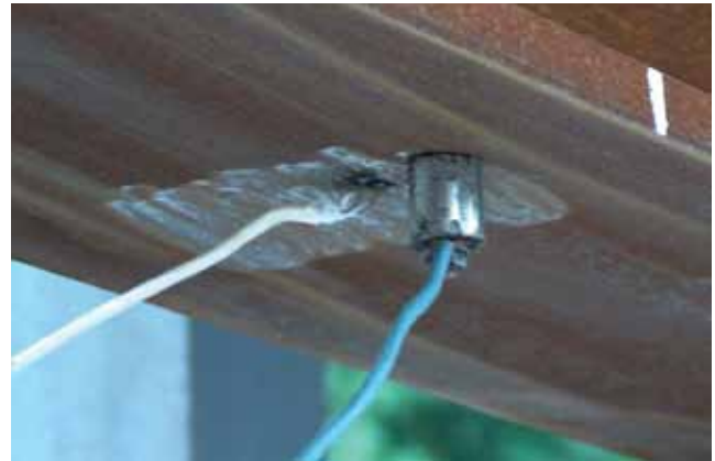
Slika 2. Termoelement na mjernoj poziciji
