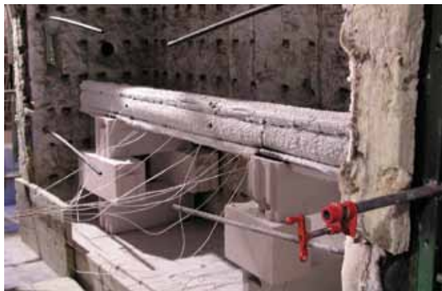
Slika 1. Prikaz čeličnog elementa* unutar peći dimenzija 3150 x 3000 x 1000 mm
