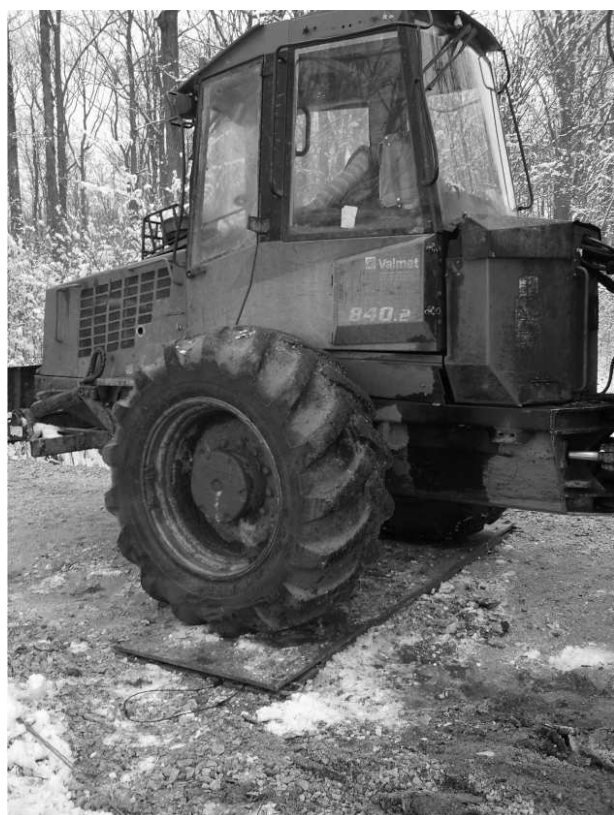
Slika 3. Prijenosne vage ugrađene u kovinsko kućište Fig. 3 Portable scales inside metal case
