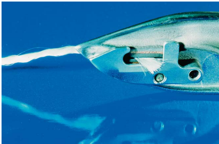
Sl.1 Pozitivno upravljana glava hvatala na tkalačkim strojevima tvrtke Dornier
