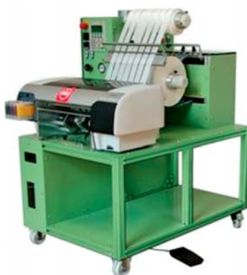
Sl.1 Stroj za tisak mlazom tinte MDP2 MÜPRINT2 tvrtke Jakob Müller AG
