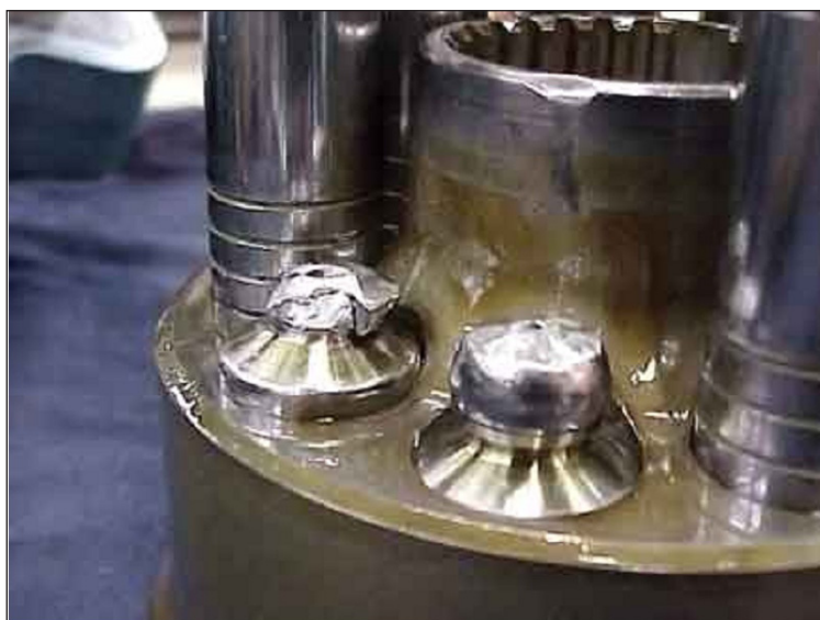
Slika 1. Oštećenje klipova aksijalno-klipnog hidrauličnog stroja [9] Figure 1 Damage to pistons of the axial-piston hydraulic machines [9]
