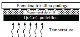
Slika 14. Presjek transferne folije pogodne za prihvaćanje tinta bojila na bazi organskih otapala [11]
