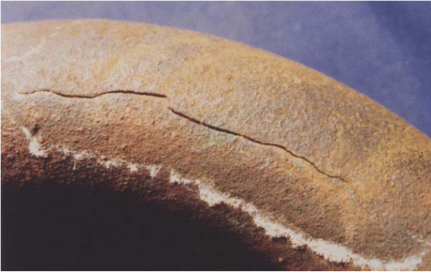
Slika 10. Primjer napetosne korozije ugljičnog čelika – interkristalni karakter loma [5]
