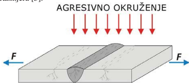
Slika 3. Čimbenici koji utječu na pojavu napetosne korozije [6]
