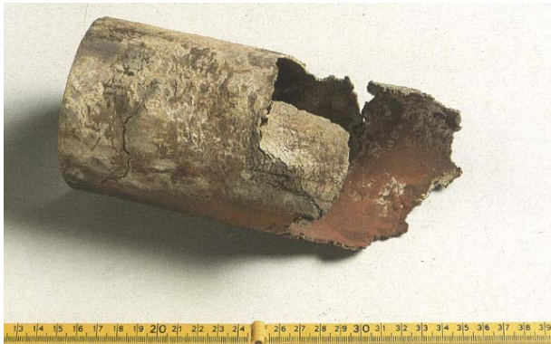
Slika 17. Kloridna napetosna korozija AISI 316 čelika – transkristalan lom [5]
