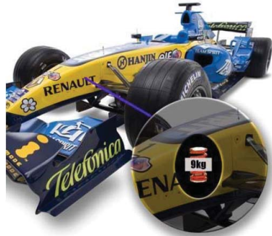
Slika 2. Pasivni dinamički prigušivač na Renault-ovom bolidu [3]
