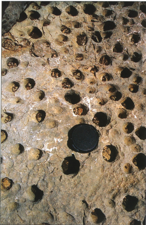
Fot. 16. Biokorozijska udubljenja nastala korozijskim djelovanjem bakterija, lišajeva i mahovina
