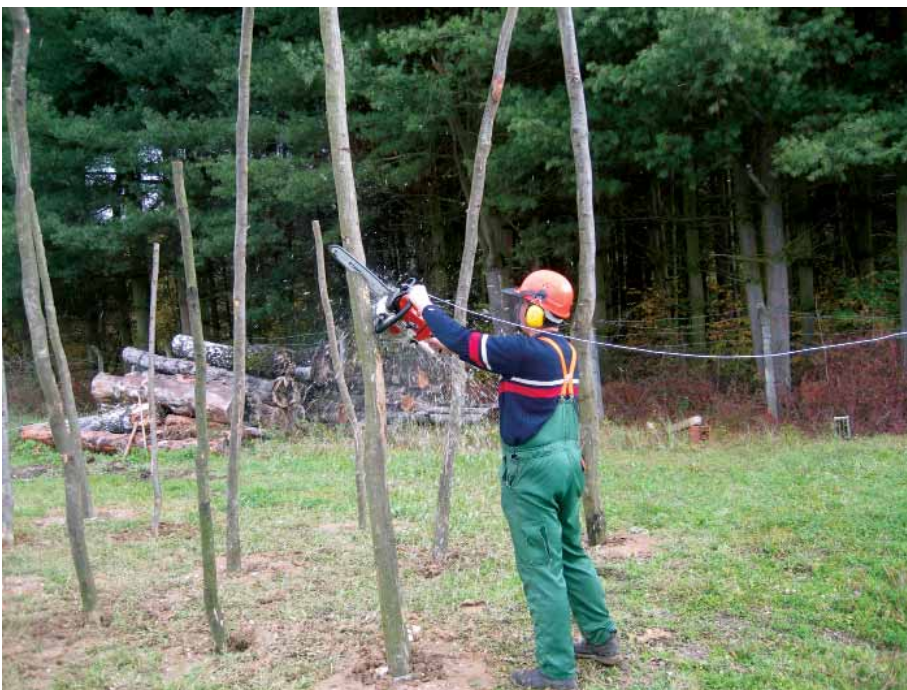
Slika 4: Mjerenje vibracija pri rezanju u simuliranim uvjetima
