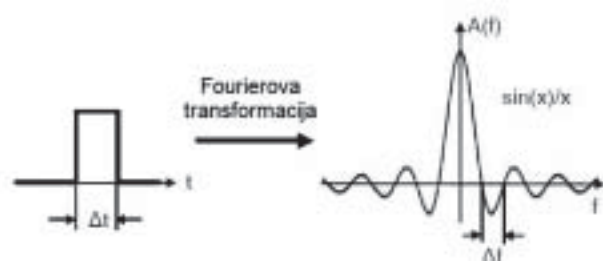
Slika 4. Fourierova transformacija pravokutnog impulsa [1]
