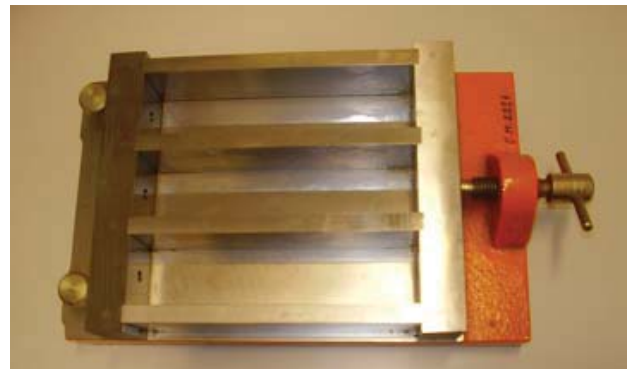
Slika 7. Trodijelni kalup dimenzija 4x4x16 cm za izradu uzoraka glazure za ispitivanje tlačne i savojne čvrstoće
